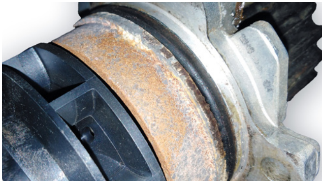
Afbeelding 1: Corrosiesporen op een koelvloeistofpomp
